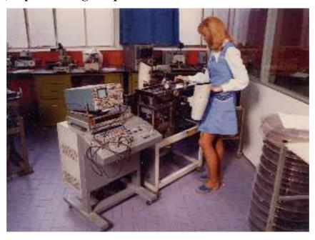
Caractéristiques mesurées: Longueur de la belt. Hauteur sur les poulies. Saut. Lecture des trous par les capteurs magnétiques.
