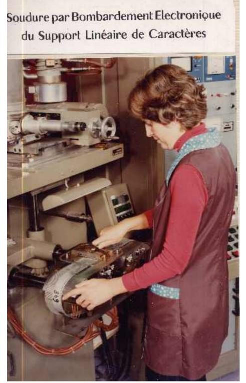
La soudure par bombardement électronique a été utilisée avant la soudure laser. Elle a été abandonnée pour les raisons suivantes :
